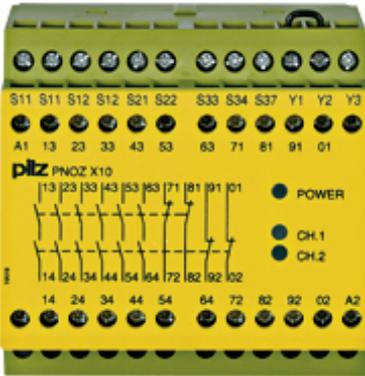
Sicherheitsschaltgerät (standalone), Eingänge: 1/2-kanalige Beschaltung mit/ohne Querschlusserkennung, Ausgänge: 6 S, 4 Ö, automatischer/manueller/überwachter Start und automatischer Start mit Anlaufzeit, UB = 24 V DC, Breite: 90 mm, Schraubklemmen integriert, Überwachung von Not-Halt, Schutztüren.
