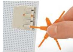
Kodieren einer THT-Stiftleiste durch Einschieben eines Kodierstiftes
