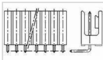
PCB-Steckverbindermontagetyp: **Stiftleiste für die Leiterplattenmontage**
