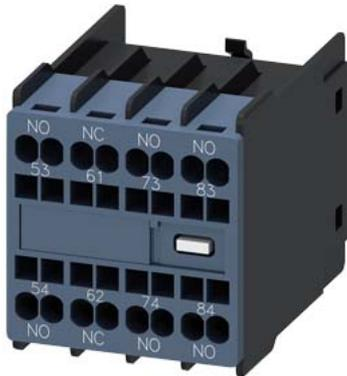
Hilfsschalter frontseitig, 3 S + 1 Ö Strombahn 1 S, 1 Ö, 1 S, 1 S für 3RH2 und 3RT2 Federzuganschluss 53/54, 61/62, 73/74, 83/84
