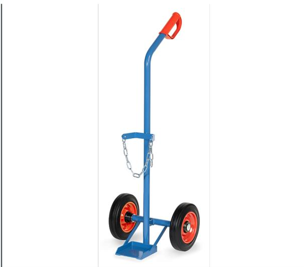
Stahlflaschenkarre aus Stahlrohr geschweißt, pulverbeschichtet blau RAL 5007. Flaschenhalterungen mit Kettensicherung. Räder mit Vollgummibereifung, Naben mit Rollenlager.
