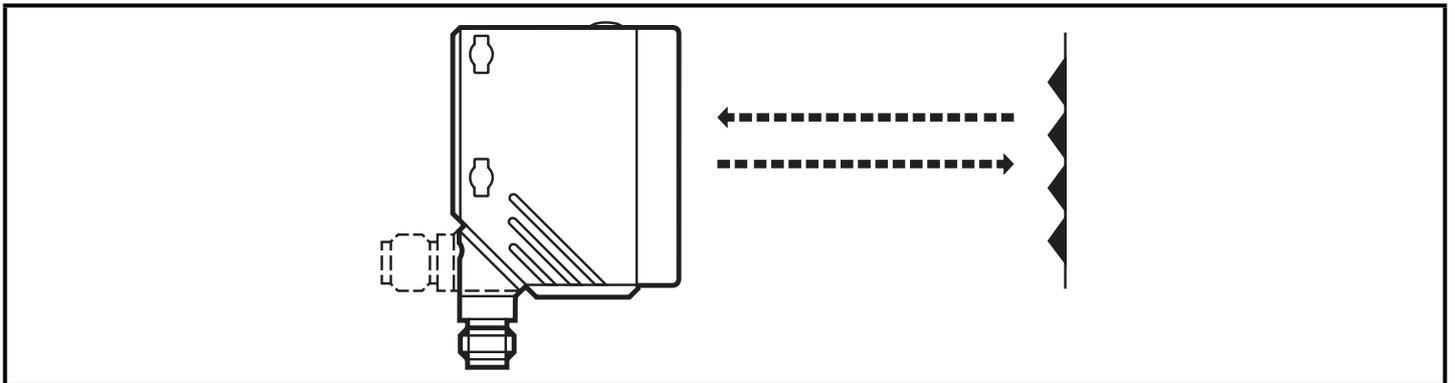
▶ Den Tripelspiegel oder die Reflexfolie hinter dem zu erfassenden Objekt anbringen.
