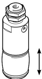
Die angegebenen Öffnungs- und Schließzeiten [ms] wurden bei Raumtemperatur, 6 bar Betriebsdruck und bei senkrecht eingebautem Greifer gemessen. Die Zeiten beziehen sich auf den unbelasteten Greifer. Je nach Ausführungsvariante ist die Verformung des Balges als Öffnungszeit und die Rückstellung als Schließzeit deklariert.
