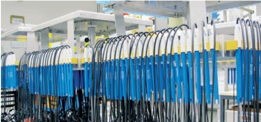
Sorgfältige Qualitätskontrollen gehören von Anfang an dazu. Bei jeder pH-Elektrode werden Nullpunkt, Steilheit und Einstellzeit geprüft - wie hier bei einer Partie BlueLine Laborelektroden.
