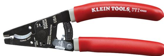
Der Klein Tools Multi-Kabelschneider verfügt über eine breite Palette von Klingen, die zum Schneiden von zahlreichen Kabeltypen entwickelt wurden. Der Ambossschneider schneidet 12 AWG Kupferdraht und Edelstahl bis zu 0,032 Zoll Durchmesser. Die gekrümmte Schneide schneidet 8 AWG Kupfer-Massivdraht und 6 AWG Kupferlitze, Mehrleiterkabel und Koaxialkabel. Dieses Werkzeug hat auch ein Messer für Weichstahl.
