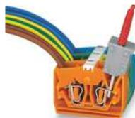
Tippkontaktierung, über die Feder des CAGE CLAMP®-Anschlusses, begrenzt den Nennstrom auf maximal 0,5 A und die maximale Prüfspannung auf 48 V; die Prüfstifte sind nicht berührungsgeschützt.
