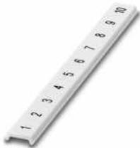
Zackband flach, Streifen, weiß, beschriftet, längs bedruckt: fortlaufende Zahlen 1 ... 10, 11 ... 20 usw. bis 91 ... 100, Montageart: verrasten, für Klemmenbreite: 6,2 mm, Schriftfeldgröße: 5,15 x 6,15 mm, Anzahl der Einzelschilder: 10
