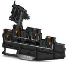
Sicherungsreihenklemme, Art der Sicherung: Glas / Keramik / ..., Sicherungstyp: G / 5 x 20, Nennspannung: 500 V, Nennstrom: 28 A, Anschlussart: Push-in-Anschluss, Bemessungsquerschnitt: 4 mm<sup>2</sup>, Querschnitt: 0,2 mm<sup>2</sup>- 6 mm<sup>2</sup>, Anschlussart: Push-in-Anschluss, Bemessungsquerschnitt: 4 mm<sup>2</sup>, Querschnitt: 0,2 mm<sup>2</sup>- 6 mm<sup>2</sup>, Montageart: NS 35/7,5, NS 35/15, Farbe: schwarz
