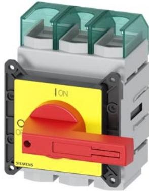
SENTRON, Lasttrennschalter 3LD, Not-Aus-Schalter, 3- polig, Iu: 160 A, Betriebsleistung / bei AC-23 A bei 400V: 75 kW, Frontbefestigt, Knebelantrieb, rot/gelb, 4-Loch Befestigung der Handhabe
