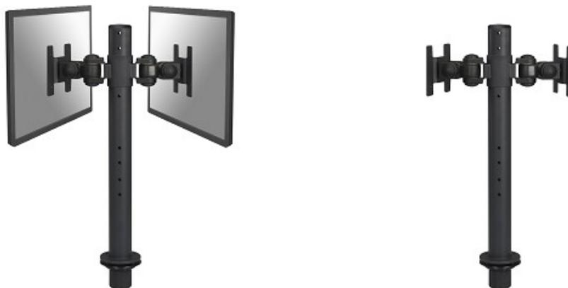
Questo braccio porta monitor NewStar, modello FPMA-D050DBLACK consente di collegare due schermi LCD/LED/TFT in senso opposto su di una scrivania con la modalità di fissaggio su piano attraverso viti e foro passante con anello di tenuta.
