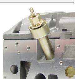
📷 12: Glühkerze nach Herstellervorgaben in den Zylinderkopf einschrauben.
