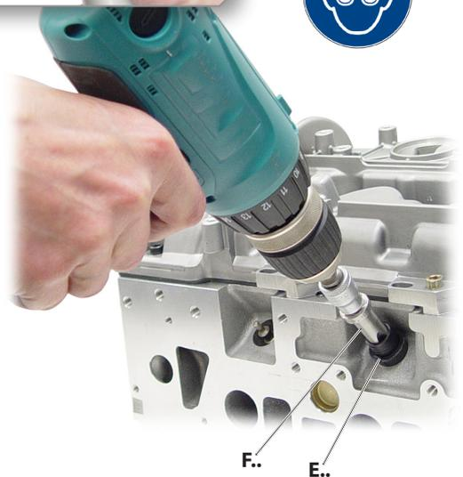
**9:** Gewindebohrer [G..] mit Spiritus bestreichen und das Aufnahmegewinde für die Gewindehülse [D..] schneiden.
