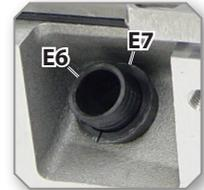
1. Setzen Sie die ausgewählte Führungshülse [E..] vollständig an der Glühkerzenbohrung ein.
