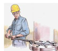
**Achten Sie unbedingt auf darauf, die Dichtung mit ausreichend Flächenpressung einzubauen!**
