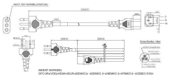
1ÖVE D+ ∞ + ∞ + ∞ IEMMEQU NF-USE-1291-H05VV-F 3G 0.75mm<sup>2</sup> Dimensions: Millimetres
