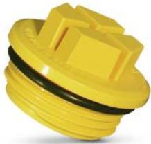
Die Dichtstopfen mit O-Ring GPN 737 sind passend für das Verschließen von Einschraubblöchern nach DIN 3852-1 und DIN ISO 6149-1 und besonders geeignet für erhöhte Dichtigkeitsanforderungen. Das robuste Material ist hochwertig und besonders schlagzäh. Die umlaufende Dichtlippe, die ohne Formtrenngrad ausgeführt ist, und der O-Ring verhindern innerhalb gewisser Grenzen das Eindringen und Austreten von Flüssigkeiten. Die Montage erfolgt durch Schraubendreher oder Schraubenschlüssel.
