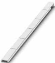
Zackband, Streifen, weiß, unbeschriftet, beschriftbar mit: CMS-P1-PLOTTER, PLOTMARK, Montageart: verrasten, für Klemmenbreite: 18 mm, Schriftfeldgröße: 18 x 5 mm, Anzahl der Einzelschilder: 5
