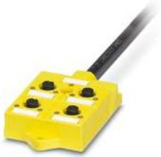
Die Sensor-Box PSR-SACB für Sicherheits-Endschalter verschaltet sicherheitstechnisch bis zu 4 angeschlossene Endschalter mit je 1 Öffner und 1 Schließer an eine Sicherheitsrelais-Kombination, z.B. PSR-SDC4, Kabellänge: 10 m
