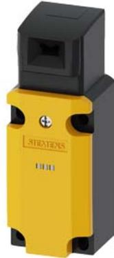
Sicherheits-Positionsschalter mit getrenntem Betätiger Kunststoffgehäuse 40 mm 1 x (M20 x 1,5) Schleichschaltglieder 1S+2Ö mit 2 LEDs gelb/grün 230 V AC 5 Anfahrrichtungen der dazu passende getrennte Betätiger 3SE5000-0AV0. muss separat bestellt werden
