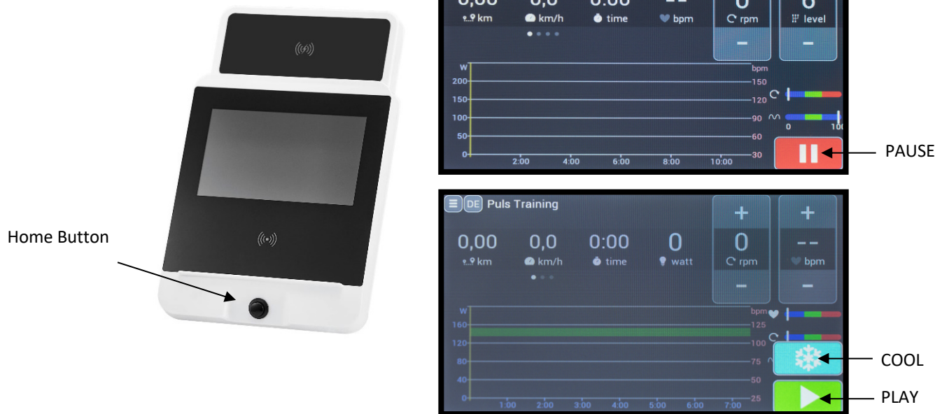
Abb. 2: Monitoransicht, zur Erklärung der Tastenfunktionen, tatsächliche Ansicht kann farblich variieren, Tastenbelegung ist gleich.
