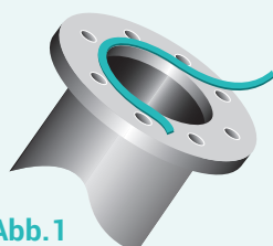
2.1. b Anbringen des Dichtungsbandes
