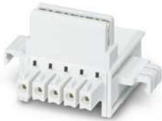
Tragschienen-Busverbinder, Farbe: lichtgrau, Nennstrom: 8 A (parallele Kontakte), Bemessungsspannung (III/2): 125 V, Kontaktfläche: Gold, Polzahl: 5, Rastermaß: 3,81 mm, Montage: Tragschienenmontage, Verriegelung: ohne, Befestigungsart: ohne, Verpackungsart: verpackt im Karton, Artikel mit vergoldeten Kontakten, Busstecker zur Verbindung mit Elektronikgehäusen, 5 Parallelkontakte
