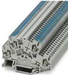
Doppelstock-Zugfederklemme, Nennspannung: 500 V, Nennstrom: 22 A, Anschlussart: Zugfederanschluss, 1. und 2. Etage, Bemessungsquerschnitt: 2,5 mm<sup>2</sup>, Querschnitt: 0,08 mm<sup>2</sup> - 4 mm<sup>2</sup>, Montageart: NS 35/7,5, NS 35/15, Farbe: grau
