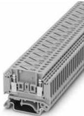
Thermospannungsklemmenpaar, TC Typ J, Nennspannung: 400 V, Nennstrom: 1 A, Anschlussart: Schraubanschluss, 1. Etage, Querschnitt: 0,2 mm<sup>2</sup> - 4 mm<sup>2</sup>, Montageart: NS 35/7,5, NS 35/15, NS 32, Farbe: grau
