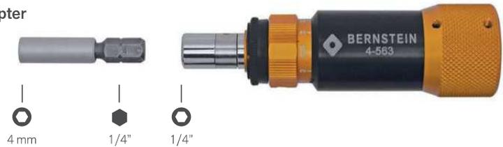
Der Drehmomentschraubendreher verfügt über eine Innensechskant Bit Aufnahme 1/4 Zoll (6,3 mm) mit einer Klemmkugel. Das einstellbare Drehmoment von 0,05 bis 0,6 Nm kann über eine Rändelschraube auf die gewünschte Größe eingestellt werden, Toleranz (+/-6%). Der eingestellte Wert kann dann verriegelt werden.
