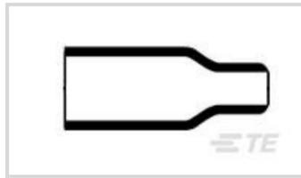
Form des Formteils: **Gerade**Formcode des Formteils: **202**Mit Rand: **Nein**Materialcode: **25**Materialsystemcode: **25**
