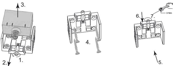
1. Lösen Sie die Zentralschraube unterhalb des Sensoranschlusses.
