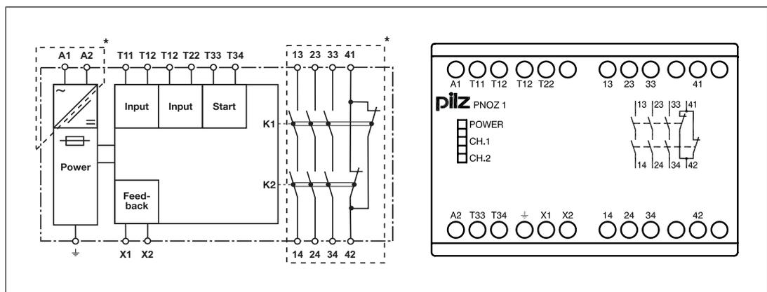
\*Isolation zum nicht markierten Bereich und der Relaiskontakte zueinander: Basisisolierung (Überspannungskategorie III), sichere Trennung (Überspannungskategorie II)
