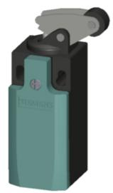
SIRIUS POSITIONSSCHALTER; KUNSTSTOFFGEHAEUSE NACH EN50047, 31MM GERAETEANSCHLUSS 1X(M20X1,5); 1S/10E SPRUNGKONTAKTE INTEGRIERT (NICHT AUSTAUSCHBAR) WINKELROLLRNHEBEL MIT KUNSTSTOFFROLLE 13MM
