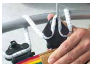
Erhöhen der Spannung durch Veränderung der Kabelführung von Position 3 zu Position 4.
