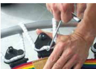
Erhöhen der Spannung durch Veränderung der Kabelführung von Position 3 zu Position 4.
