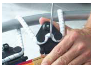
Erhöhen der Spannung durch Veränderung der Kabelführung von Position 3 zu Position 4.
