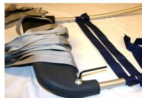
Die langen Rohre (Teil B) in den Aufprallschutz einschieben, Ecken zusammendrücken bis die Sicherheitsstifte einrasten und Schraube mit Gewindegewinde mit Sechskant-Stiftschlüssel anziehen (~15 Nm) bis die Ecken geschlossen sind. Kurze Bänder (Teil G) auf die langen Rohre auffädeln.
