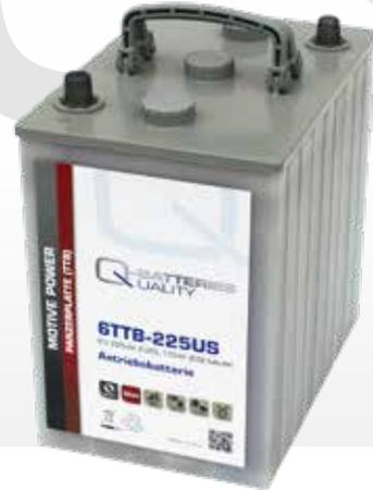
Diese Bleiakkus sind geschlossene Antriebsbatterien mit positiven Röhrenplatten, auch bekannt als Panzerplatten-Technologie. Sie sind besonders darauf ausgelegt in rauer Umgebung eine verlässliche Leistung für den Einsatz in Traktionsanwendungen zu gewährleisten. Das optional erhältliche Wasserbefüllsystem ermöglicht einen leichten und sicheren Ausgleich bei Wasserverlust der Batterien.
