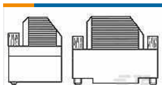
TE Teilnr.: CAT-038-DCPPS221 D-Sub-Crimpverbindung: Stecker, Signal, 50 Positionen, Stiftgröße 22, Gehäusegröße 1
