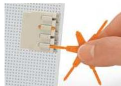
Kodieren einer THT-Stiftleiste durch Einschieben eines Kodierstiftes
