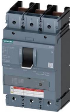
Leistungsschalter 3VA5 UL Frame 400 3polig, Starterschutz TM120M, AM, In=250A ohne Überlastschutz Kurzschlusschutz Ii=6...12 x In ohne Anschluss
