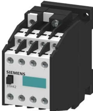
Hilfsschütz, 53E, DIN EN 50011, 5 NO + 3 NC, Schraubanschluss AC-Betätigung AC 125V, 127V 50Hz/
