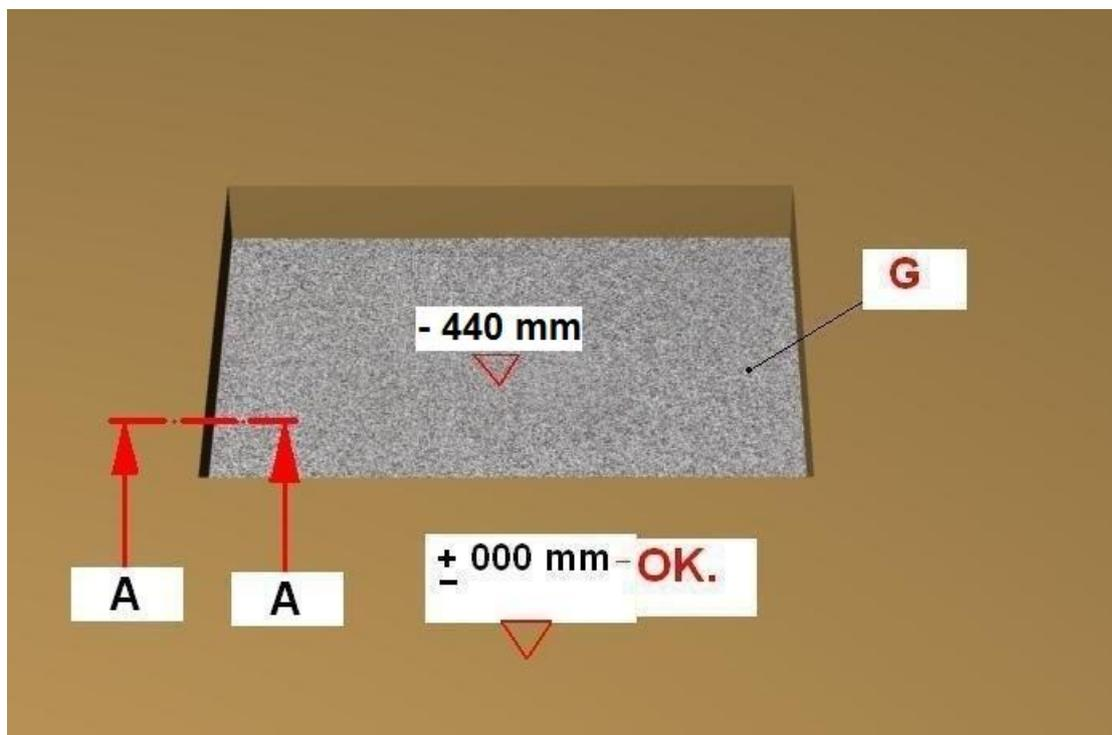
**Von Einbau in Sand raten wir wegen der sehr kurzen Reinigungsintervalle ab!**
