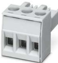
Leiterplattenstecker, Nennquerschnitt: 2,5 mm<sup>2</sup>, Farbe: lichtgrau, Nennstrom: 16 A, Bemessungsspannung (III/2): 320 V, Kontaktoberfläche: Zinn, Kontaktart: Buchse (female), Anzahl der Reihen: 1, Polzahl: 3, Artikelfamilie: MSTBT 2,5 HC/..-STP, Rastermaß: 5 mm, Anschlussart: Schraubanschluss mit Zughülse, Anschlussrichtung Leiter/Platine: 0 °, Rasthaken: - Rasthaken, Stecksystem: COMBICON MSTB 2,5 HC, Verriegelung: ohne, Befestigungsart: ohne, Verpackungsart: verpackt im Karton
