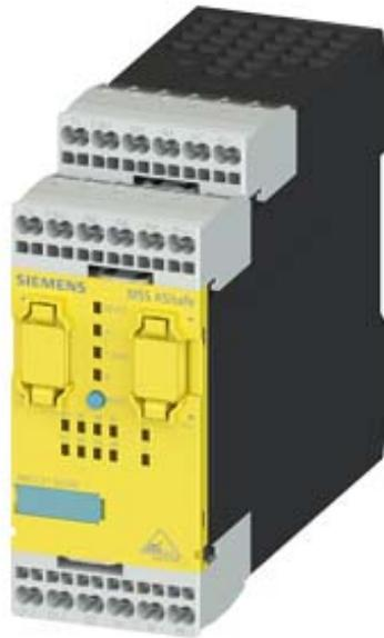
SIRIUS, Zentralmodul 3RK3 ASIsafe Basic für modulares Sicherheitssystem 3RK3 1/2F-DI,6DI,1F-RO,1F-DO,DC 24 V
