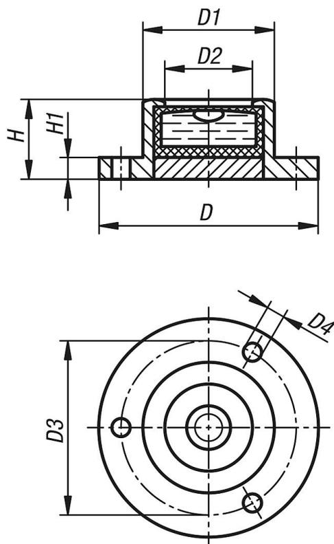
**Nivelles sphériques à visser, forme A avec bride de fixation****Aperçu des articles**
