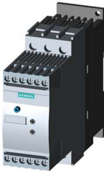
SIRIUS SANFTSTARTER, S0, 32A, 15KW/400V, 40GRAD, AC 200-480V, AC/DC 24V, SCHRAUBKLEMMEN
