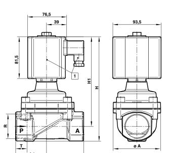
Elektromagnet um 360° drehbar
