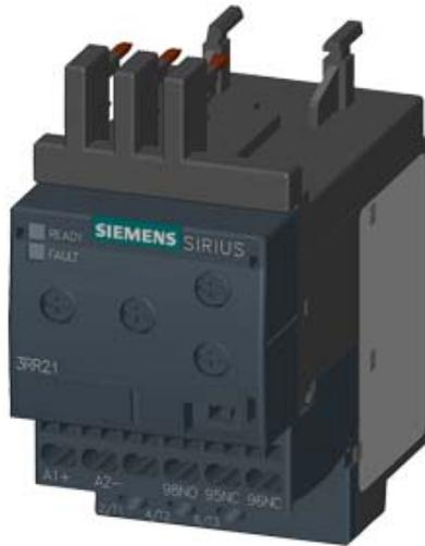
UEBERWACHUNGSRELAIS ANBAUBAR AN SCHUETZ 3RT2, BAUGROESSE S00 BASIC, ANALOG EINSTELLBAR SCHEINSTROMUEBERWACHUNG 1,6 - 16A, 50-60 HZ, 2-PHASIG VERSORGUNG 24 V AC/DC 1 WECHSLER UEBERWACHUNG AUF STROMUEBER- U. UNTERSCHREITUNG PHASENAUSFALL, DRAHTBRUCH MIT ODER OHNE FEHLERSPEICHER ANLAUFVERZOEGERUNG 0-60 S STOERSPITZENAUSSBLEND. 0-30 S SCHALTHYSTERESE 6% FEDERZUGTECHNIK
