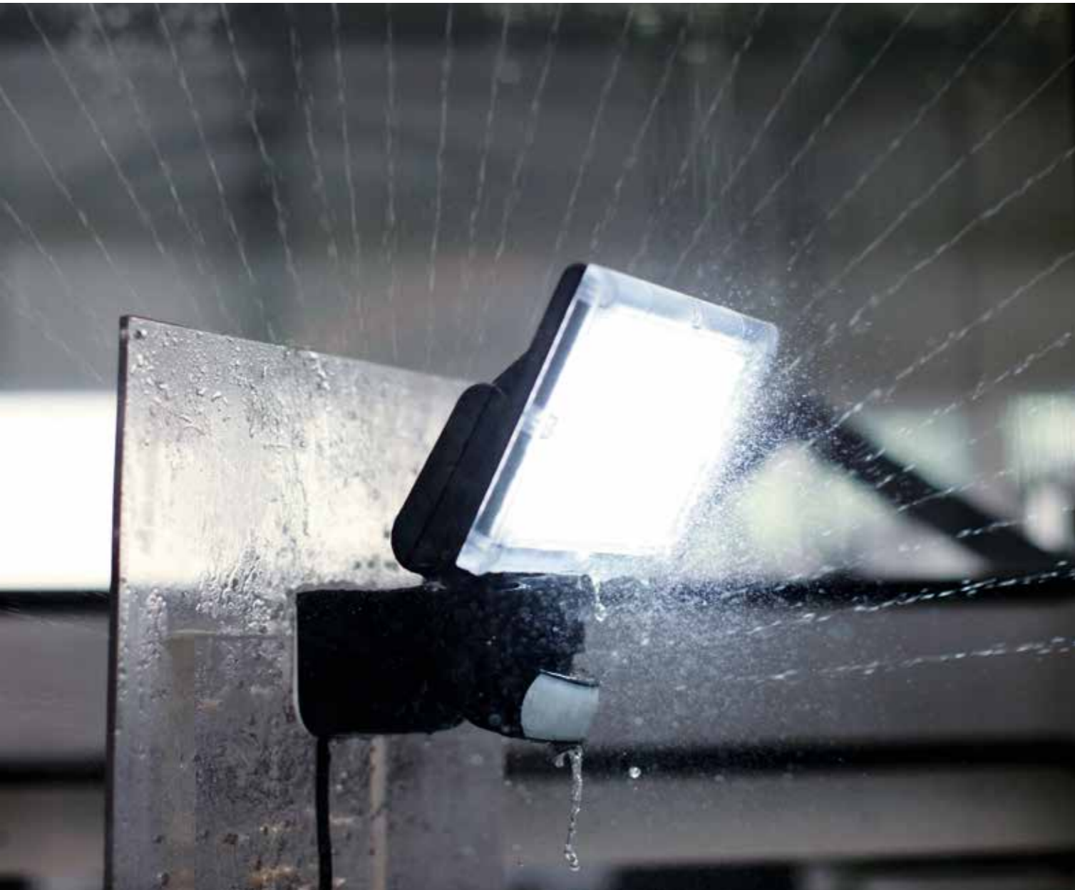
XLED home 1 im Härtestest: Unsere Spritzwasserprüfung garantiert die Wetterfestigkeit und die Schutzart IP44.
