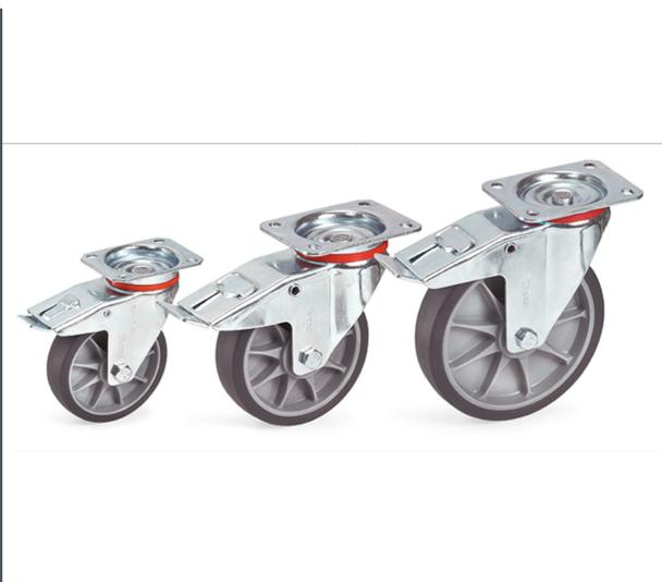
125 x 32 mm. Armature en tôle d'acier galvanisée. Roue à bandage TPE (Élastomère thermoplastique) avec frein "double stop", équipée de pare-fils, moyeu à roulement à billes de précision. Déplacement silencieux sur sols plats, peu de résistance au déplacement et à la rotation. Bandage non traçant.
