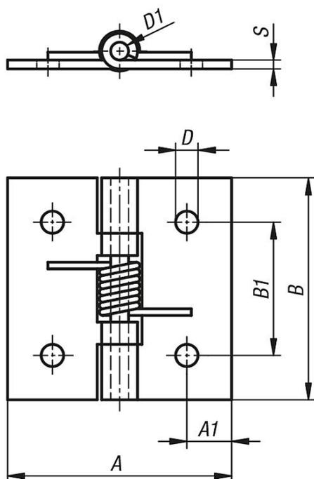
Scharniere mit Öffnungsfeder, öffnend
