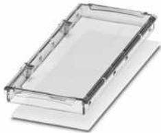
Tragschienengehäuse für den Einsatz in Installationsverteilern nach DIN 43880, transparenter Schwenkdeckel, plombierbar, inklusive Einlegeblende, Breite: 107,6 mm, Höhe: 45 mm, Tiefe: 8 mm, Farbe: transparent/lichtgrau (7035)
