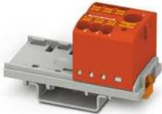
Verteilerblock, die Blöcke sind untereinander über den Leiterschacht brückbar, passende Steckbrücken siehe Zubehör, Block mit senkrechter Ausrichtung und integrierter Einspeisung, Nennspannung: 690 V, Nennstrom: 41 A, Anschlussart: Push-in-Anschluss, Sammelschluss, Bemessungsquerschnitt: 6 mm<sup>2</sup>, Querschnitt: 0,5 mm<sup>2</sup> - 10 mm<sup>2</sup>, Push-in-Anschluss, Abgriff, Querschnitt: 0,14 mm<sup>2</sup> - 4 mm<sup>2</sup>, Montageart: NS 35/7,5, NS 35/15, Farbe: rot
