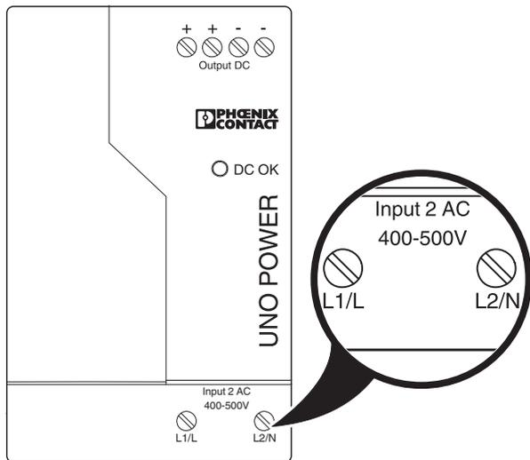
Bild 6 Schraubanschluss Input AC L1/L, L2/N
