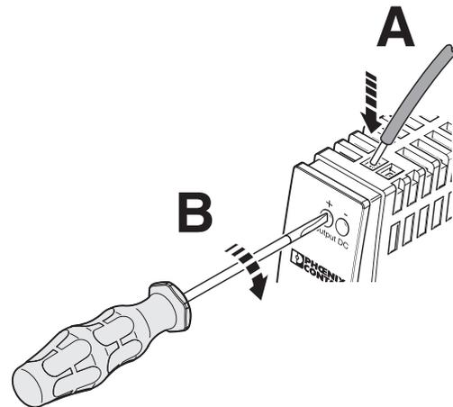
Bild 8 Leitungen anschließen
