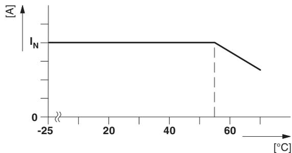
Bild 10 Temperaturabhängiges Derating
