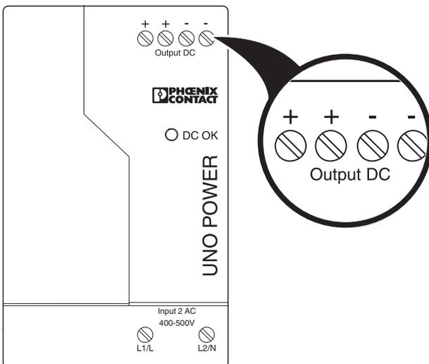
Bild 7 Schraubanschluss Output DC +/-
