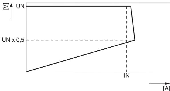
Bild 9 Ausgangskennlinie
