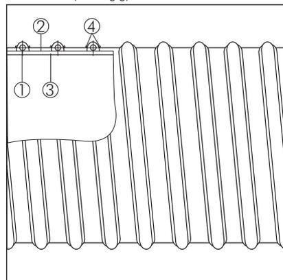
1. Spirale: Federstahl Draht
