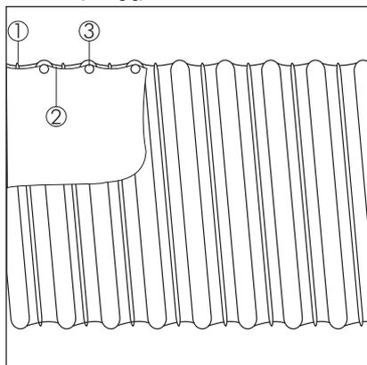
1. Spirale: Federstahl Draht
